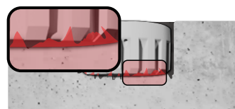
Fig. 3 Ne pas installer l'appareil sur des surfaces irrégulières ou dentelées.
