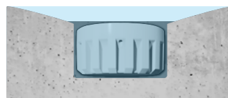
Fig. 1 Ne pas installer dans une zone inondable. L'appareil ne peut pas détecter les s lorsqu'il est immergé.
